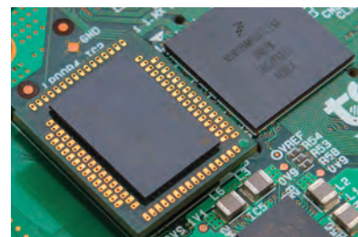
プローブアダプター・スペーサー介在時のLPDDR4-SDRAM外観(左)
